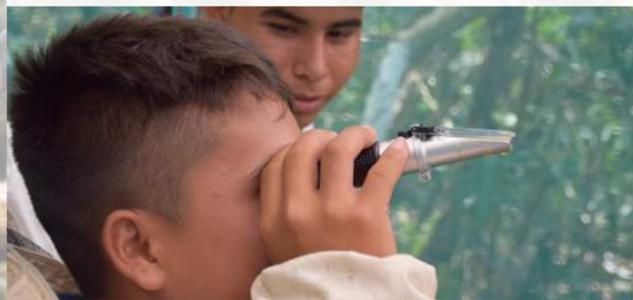
Direkt nach der Honigernte wird mit einem speziellen Messgerät der Feuchtigkeitsgrad des Honigs gemessen.
